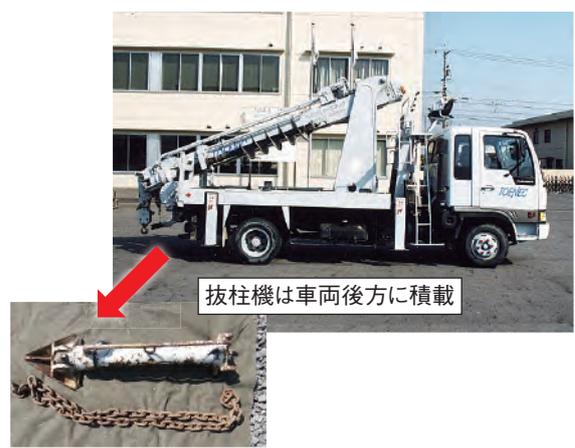
写真5 建柱車および抜柱機
