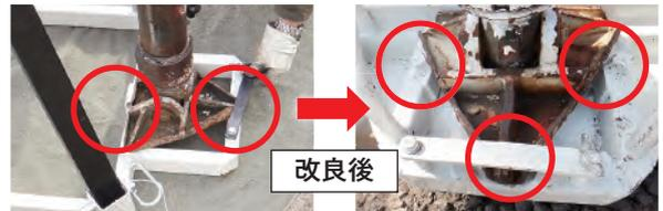
写真7 抜柱機設置箇所の改良 (2箇所から3箇所固定)
