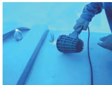
写真17 浸透探傷検査
