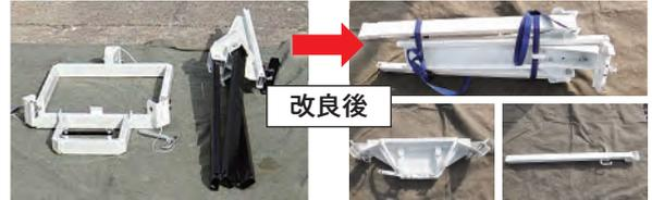
写真8 組み立ておよび運搬方法の改良 (2分割から3分割)
