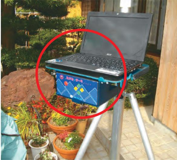
写真3 赤外線サーモカメラ操作部
