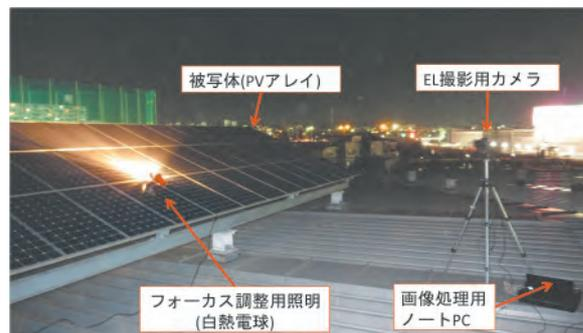
写真3 オンサイトEL測定作業の様子
