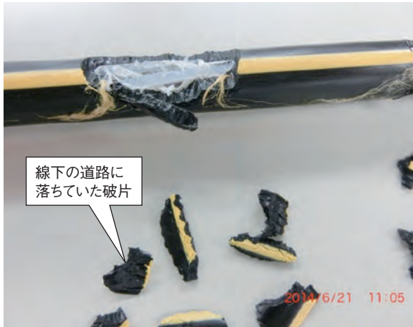
写真1 (光ファイバケーブルの被害状況) (直径11mm、材質：ポリエチレン)
