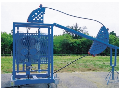
地中用長尺通信光ケーブル延線機（引張っ太郎）
