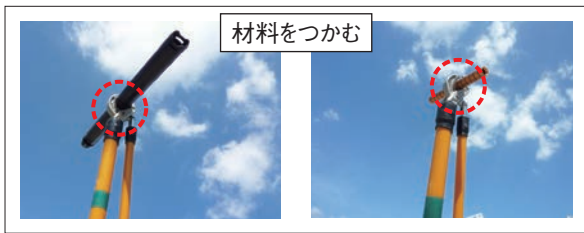
写真4 クイックヤットコ使用例
