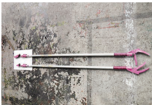
写真7 ケーブル布設用キャッチャー
