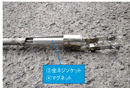
写真2 実証実験後工具(ソケット部)
