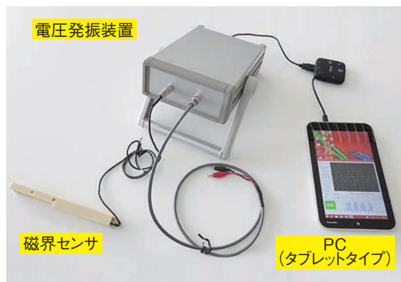
写真1 巻線短絡診断システム
