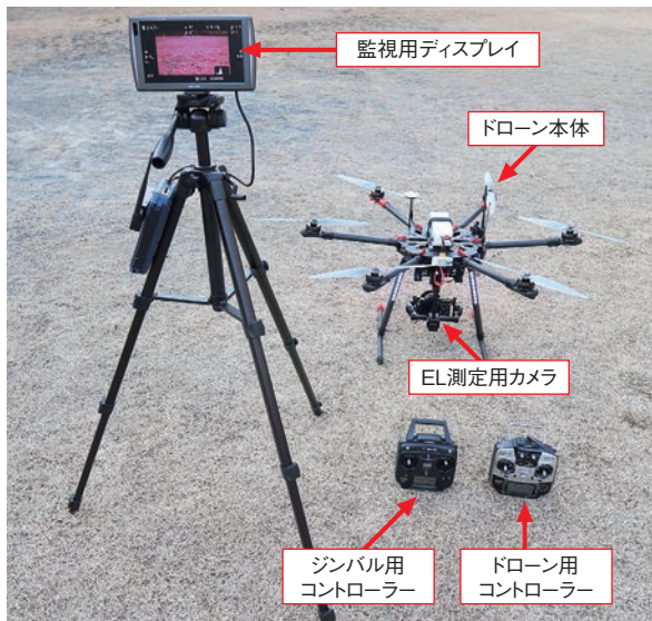
写真4 ドローンEL測定システムの概要図
