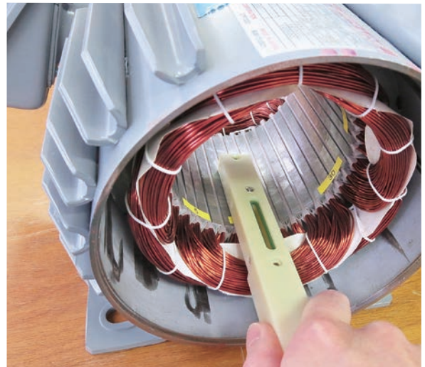
写真4 スロット上の磁界計測の様子
