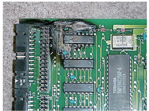
図 22 ITV 監視ユニット基盤の雷被害
