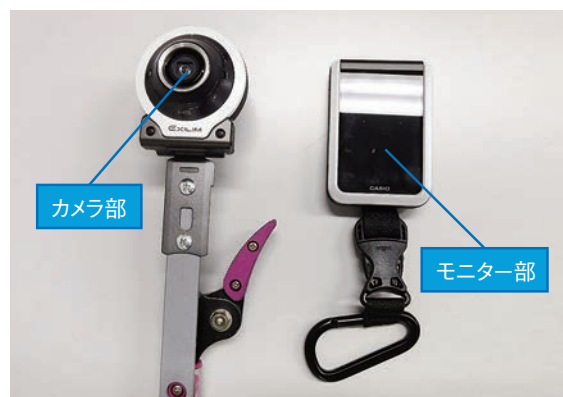
写真5 マーキング確認用カメラ (ケーブルキャッチャーに取り付けた状態)
