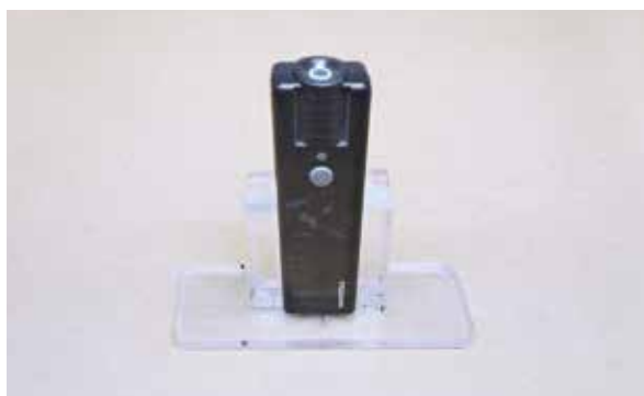
写真6 レーザーポインター固定用治具
