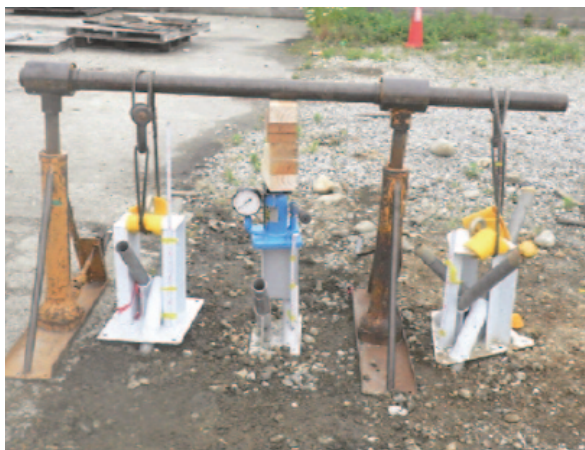
写真4 支持力試験状況
