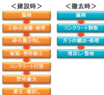
図2 現場打ちコンクリート施工手順
