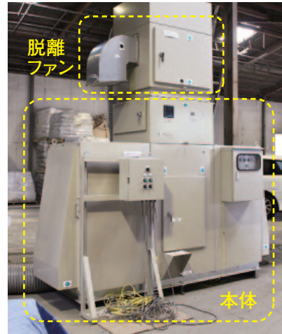
写真4 3,000 m³/hr仕様のデオマイスター実機と脱離ファン動作確認の様子
