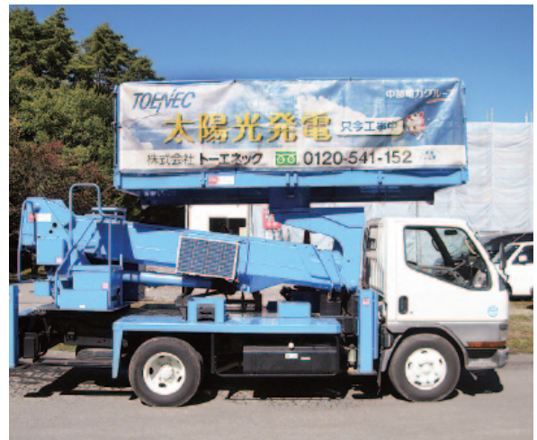
写真3 開発したプラットフォーム型高所作業車
