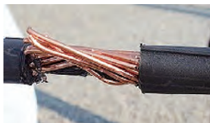
写真1 60mm²OCW素線断線(再現)
