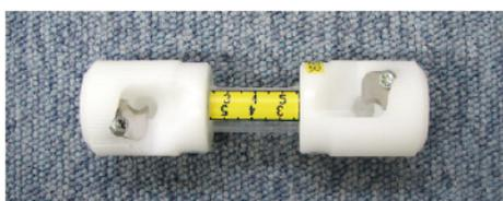
写真3 鉛筆削り方式引下げ線用皮剥ぎ器(平成10年度採用品)
