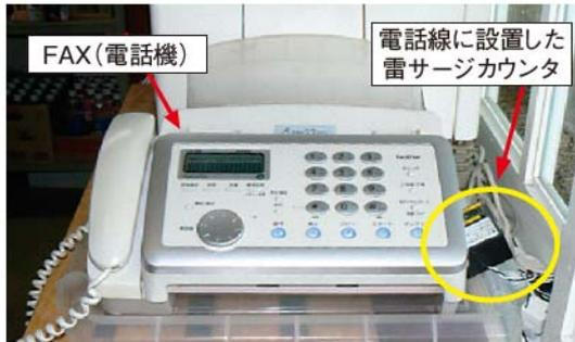
図3 FAXへの雷サージカウンタの設置例
