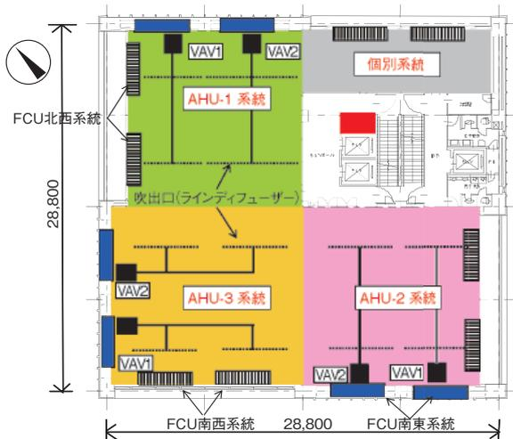
図3 基準階空調システム
