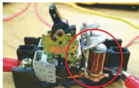
写真1 過電流遮断器の断面写真
