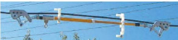
写真5 カムラーの締め付ネジを取外し、一体化した柱間切分工具とカムラー
