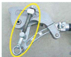
写真7 締め付ネジを取付した改良型カムラー
