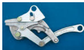
写真3 電線の張り上げ作業で使用しているヒフクカムラー
