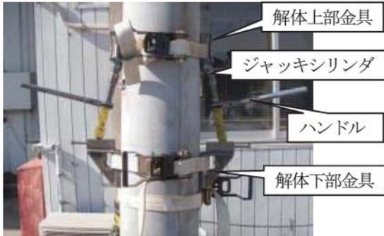
写真6 開発当初のパンザー解体工具
