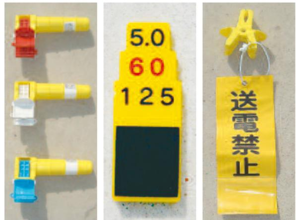
間接活線用末端キャップ 挿入確認ゲージ 送電禁止標識
