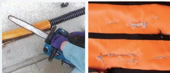
切創試験の様子：チェーンソーの歯をシートに当てても表面に浅い傷が付く程度で中の配管は保護されます。
