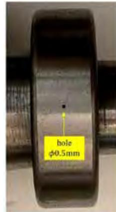
図2 ベアリング損傷
