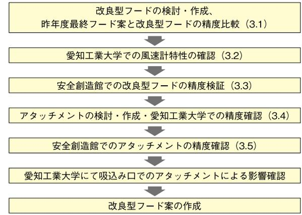
図2 風量測定手法検討と改良型フード検証
