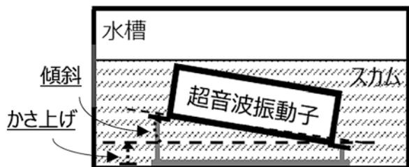
図5 超音波振動子の設置の改良方法
