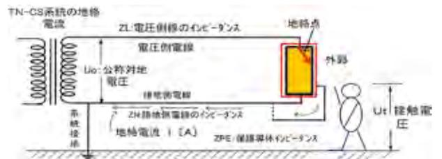
図3 TN-CS系統の地絡故障電流ループ
