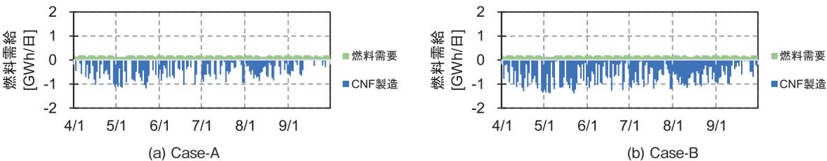
図6 愛知県新城市における日積算のCN燃料需要および余剰電力によるCN燃料供給量
