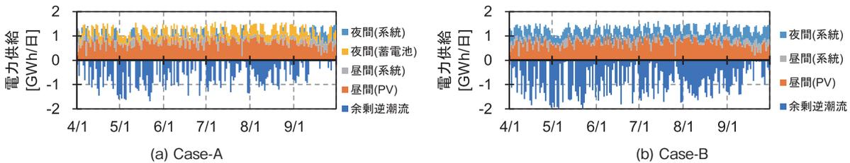
図5 愛知県新城市における日積算のPV出力・系統電力供給量
