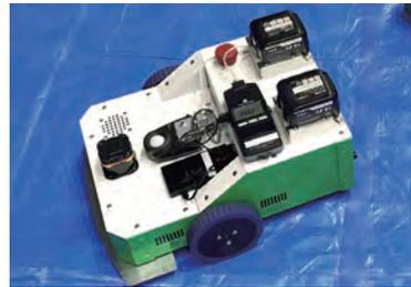
写真4 照度測定ロボット
