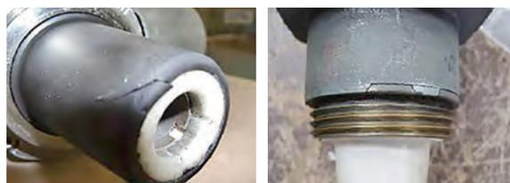
写真2 仮送電工法機材の劣化状態
