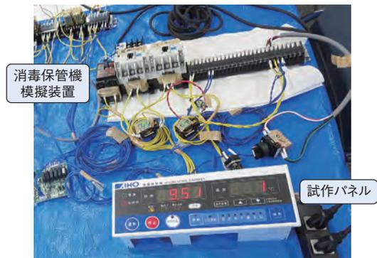
図4 消毒保管機試作パネルの動作試験
