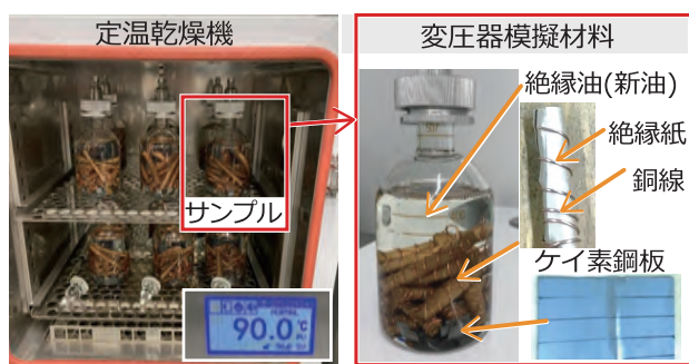
図6 熱加速劣化試験
