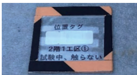
写真5 位置タグ設置状況（床面）
