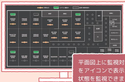
平面図上に監視対象設備をアイコンで表示し稼働状態を監視できます
