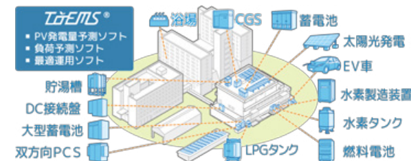
ToEMSで構築したマイクログリッドシステム (安全創造館)
