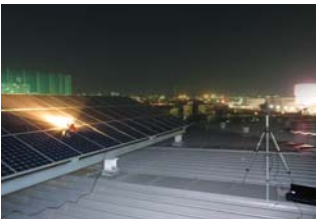
太陽光発電パネルの現地EL測定
