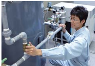
空気圧縮機の吐出能力計測
