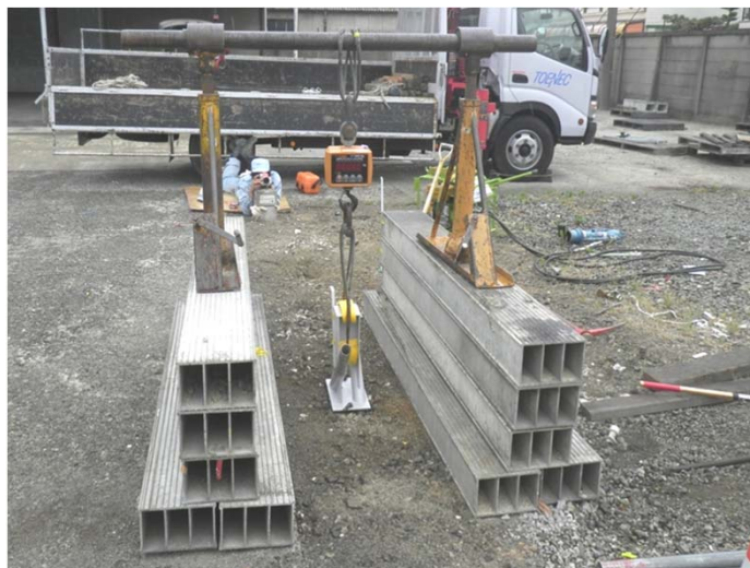
引き抜き試験状況
